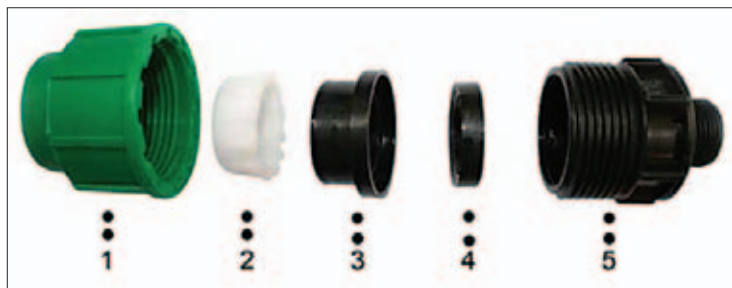
Компрессионные фитинги состоят из корпуса 5, уплотнительного кольца 4, зажимного кольца 3, запрессовывающей втулки 2 и зажимной гайки 1
