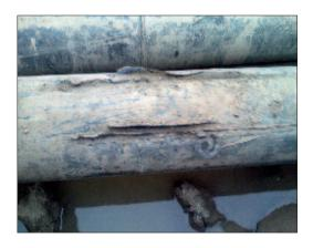
Течь в узлах трубопровода. Течь в узлах и местах соединений не является повреждением, а вызвана нарушением технологии устройства сварного соединения. Очень часто течь в полиэтиленовом трубопроводе появляется после неудачно проведенного ремонта, например, при сварке электромуфт не была полностью перекрыта подача воды в трубе. Протекание в месте стыкового соединения трубы является следствием грубых ошибок при выполнении стыковой сварки.
